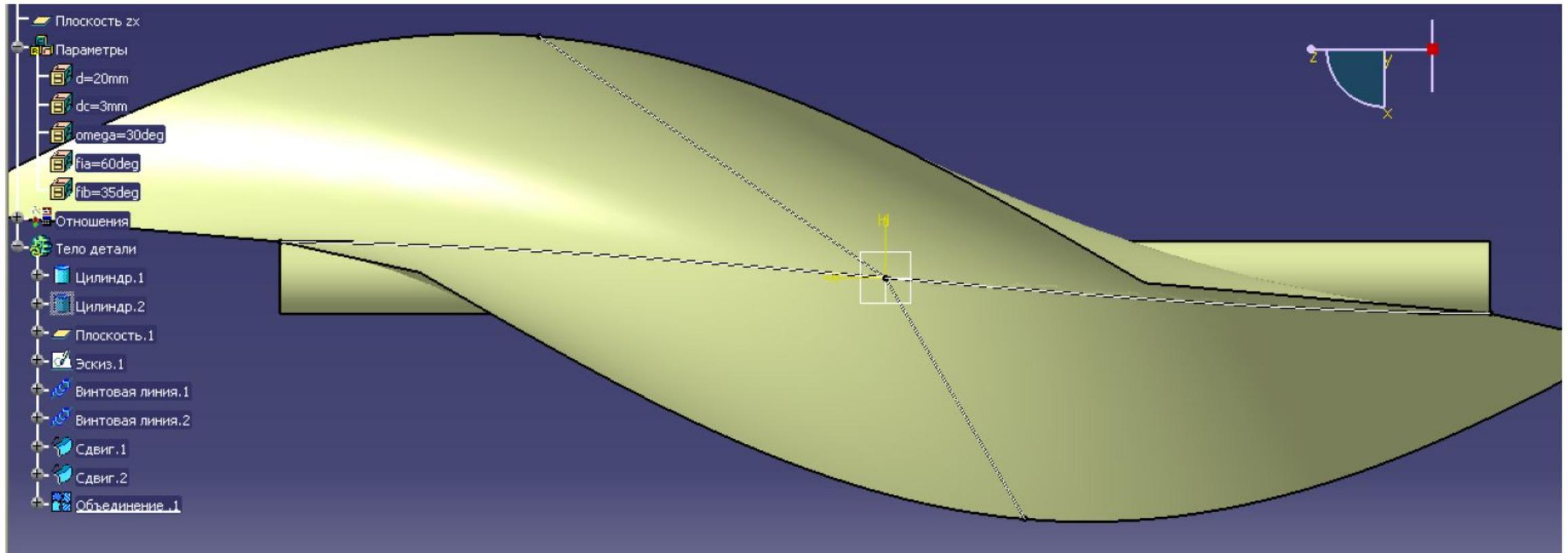
*Результат сдвига прямолинейных образующих по винтовой линии*
