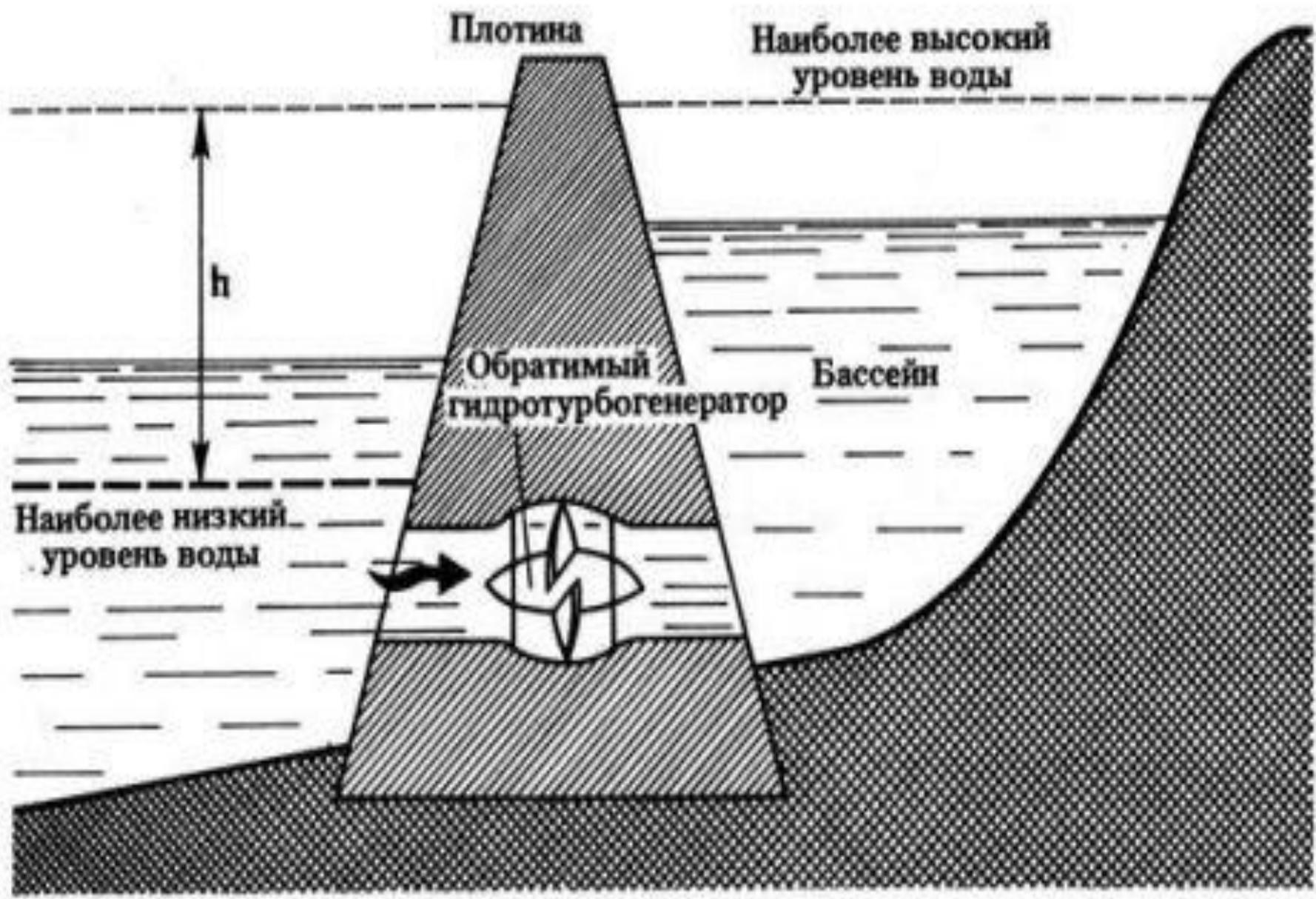
Основным элементом любой электростанции служит генератор, который вырабатывает электрический ток, разница лишь в механизме, приводящем его во вращательное движение. В варианте приливной электростанции, этим механизмом становится гидротурбина.
