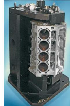
□ Приспособление для хонингования блока цилиндров дизеля
