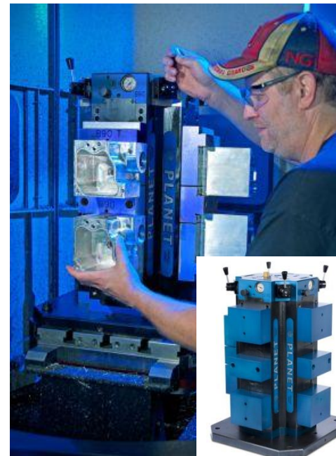
□ Снятие деталей с приспособления на базе тисочных модулей для заготовок призматического типа после завершения обработки
