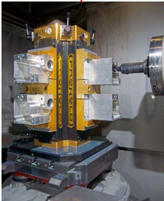
□ Процесс обработки деталей типа “Корпус” на приспособлении Томбстоун с гидроприводом зажима
