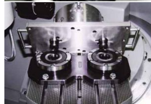
□ Пример использования квадро- и дуопаллеты с двойным и четверным настольным зажимом
