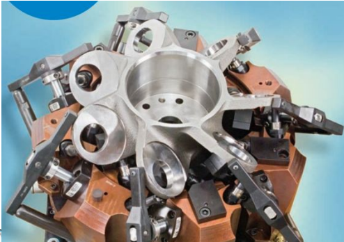
□ Приспособление для комплексной обработки (расточка отверстий) фланца несущего винта за один установ
