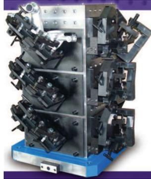
□ Специализированное многоместное приспособление для деталей типа "Рычаг"
