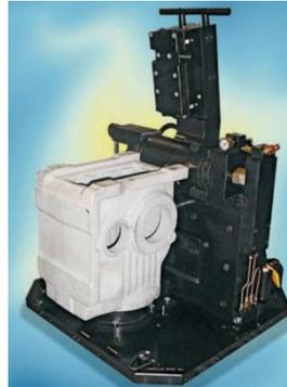
□ Приспособление для расточки отверстий редуктора
