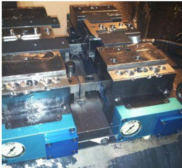
□ Тисочные модули, отдельно установленные на столе станка
