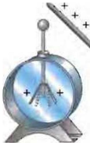
**Электроскоп**- прибор для наблюдения электрического заряда
