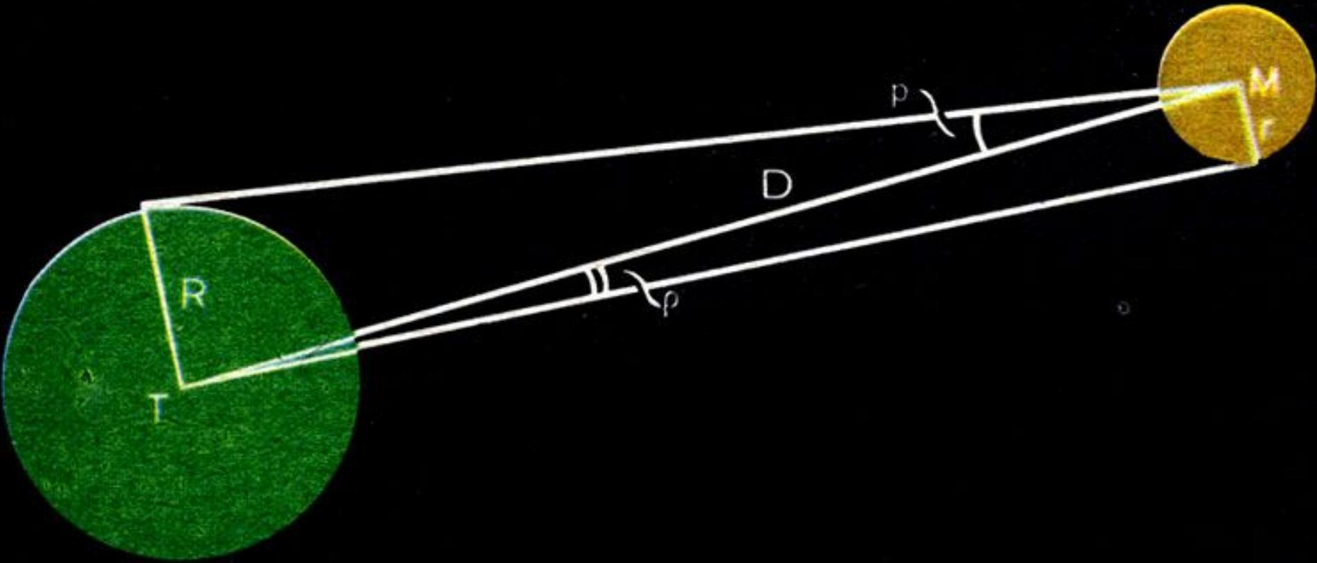
*Рис. 33. Определение линейных размеров небесных светил по их угловым размерам*
