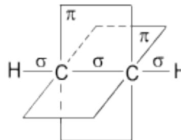
Схематическое изображение строения молекулы ацетилен (ядра атомов углерода и водорода на одной прямой, две  $p$ - связи между атомами углерода находятся в двух взаимно перпендикулярных плоскостях)
