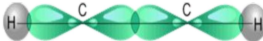
$sp$ - Гибридные орбитали двух атомов углерода в состоянии, предшествующем образованию тройной связи и связей C–H
