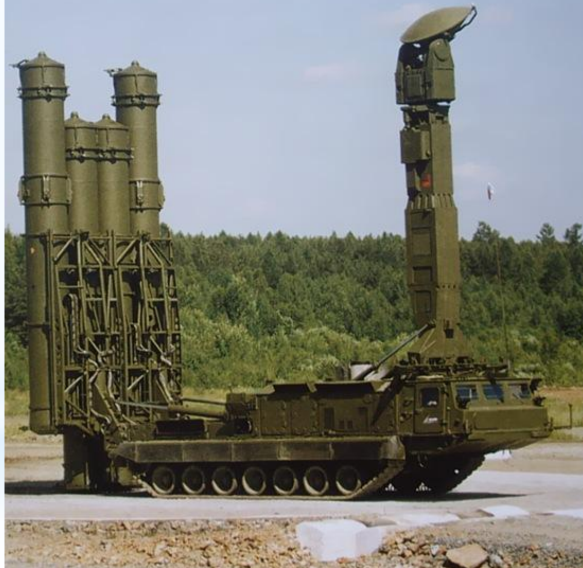
ПУ ЗРС С-300В S-300V SAM system launcher
