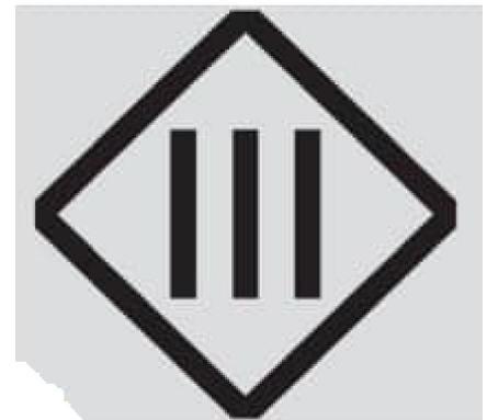
Электрооборудование класса III применяется в особо опасных условиях, когда чрезвычайно велика вероятность поражения электрическим током. Например, переносные светильники, применяемые в стесненных помещениях с проводящими полами и стенами, светильники, установленные в фонтанах и бассейнах, и другое аналогичное электрооборудование должно быть класса III.
