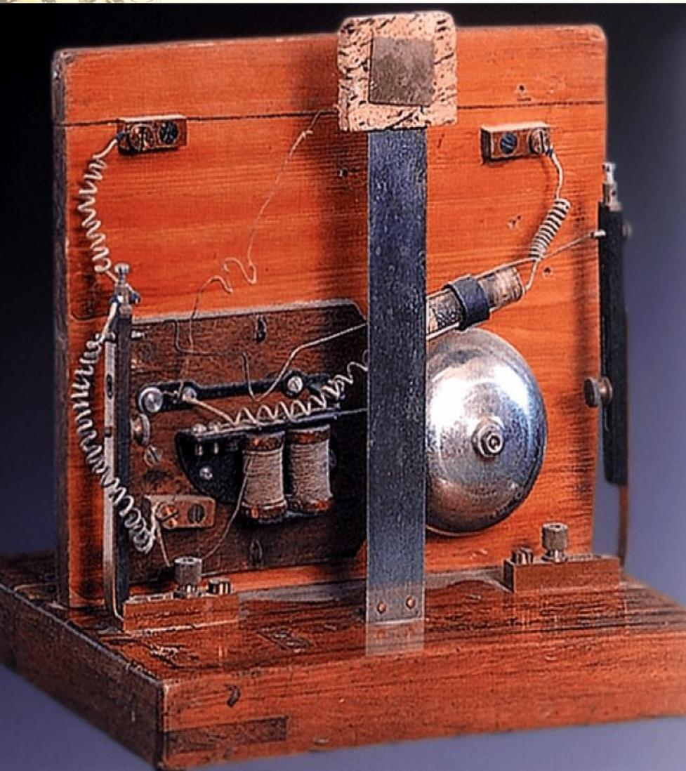
В ходе первых испытаний приемника была замечена его восприимчивость к атмосферным разрядам. А. С. Попов сконструировал специальный прибор, названный позже грозоотметчиком, для круглосуточного приема электромагнитных колебаний естественного происхождения с автоматической записью их на бумажную ленту самопишущего прибора. С июля 1895 года грозоотметчик применялся практически: для метеорологических наблюдений - в Лесном институте и для изучения атмосферных помех радиоприему - в
