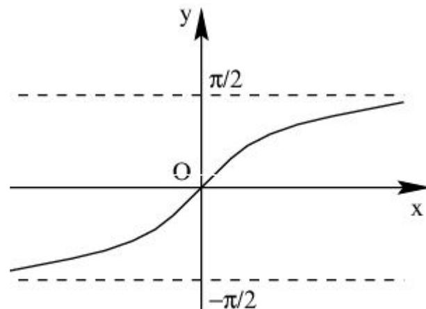
Рис. 47. График функции  $y = \operatorname{arctg} x$
