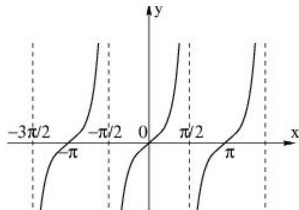
Рис. 43. График функции  $y = \operatorname{tg} x$
