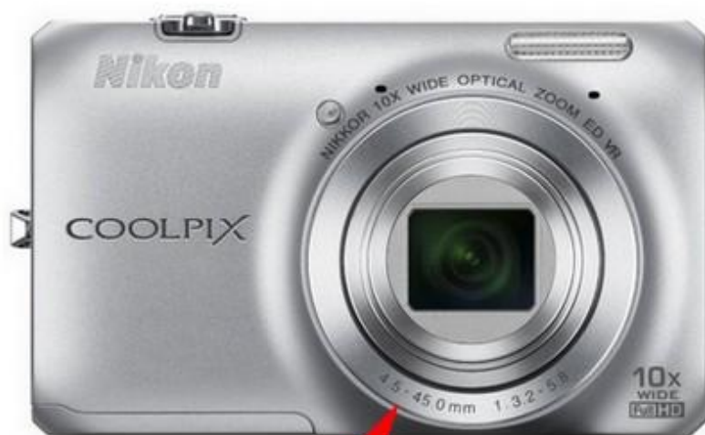
Обозначение фокусного расстояния на корпусе фотоаппарата
