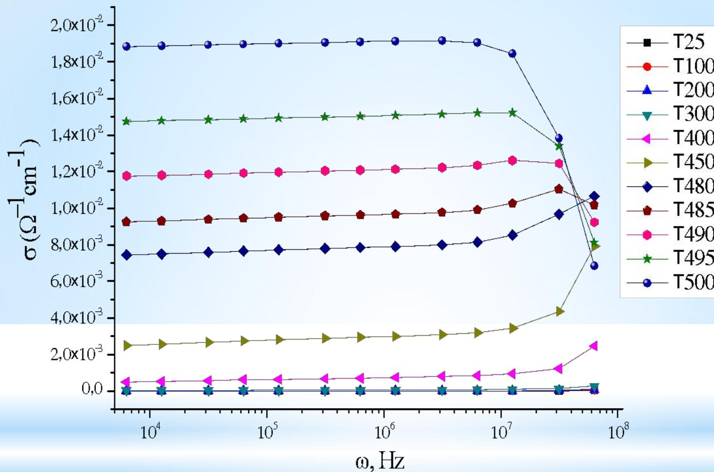
**Частотная зависимости проводимости  $\sigma_{ac}$  нанопорошка ВФО.**
