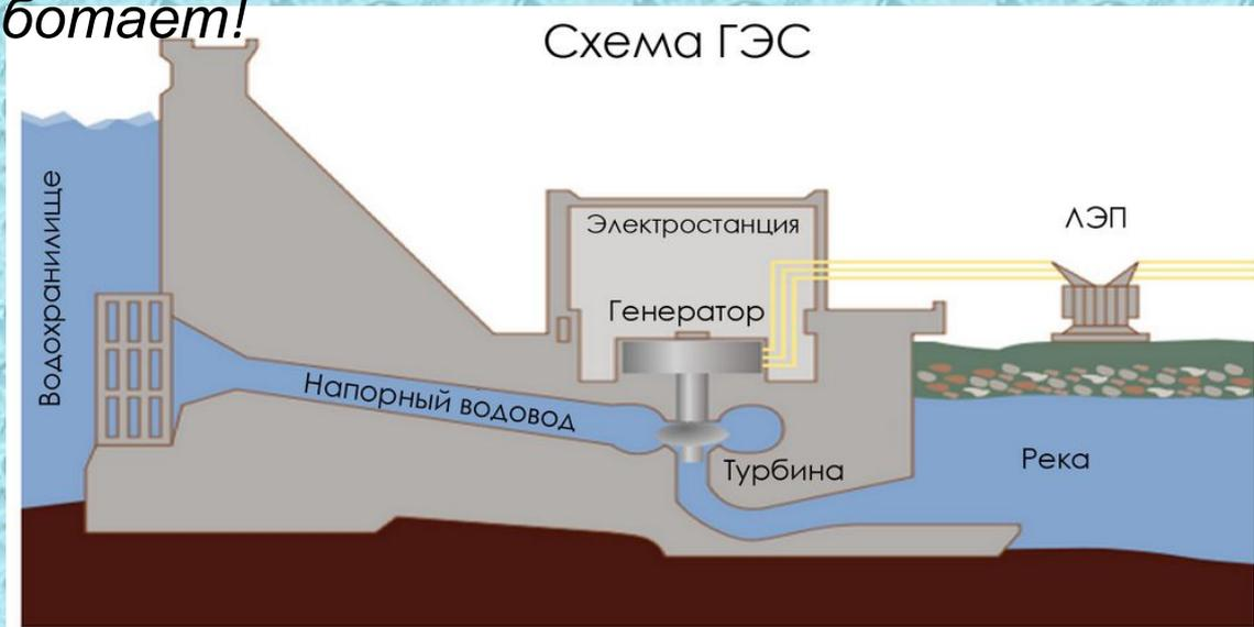
Работа гидроэлектростанции достаточно проста. Возведенные гидротехнические сооружения обеспечивают стабильный напор воды, который поступает на лопасти турбины. Напор приводит турбину в движение, в результате чего она вращает генераторы. Последние и вырабатывают электроэнергию, которую затем по линиям высоковольтных передач доставляют потребителю. Как видите, поток воды вращает турбину генератора, тот вырабатывает энергию, подает ее на трансформатор для преобразования,
