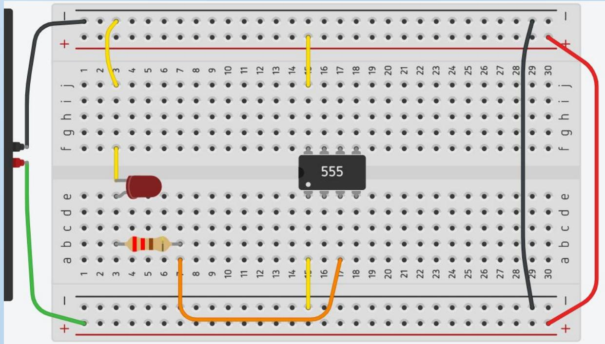
Подаем питание на микросхему, ножки 1 и 8, выход 3 соединяем с парой резистор и светодиод
