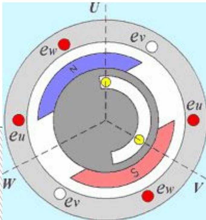
Трехфазная цепь является частным случаем многофазных систем, представляющих собой совокупность электрических цепей, в которых действуют синусоидальные ЭДС одинаковой частоты, различающиеся по фазе и создаваемые общим источником энергии.
