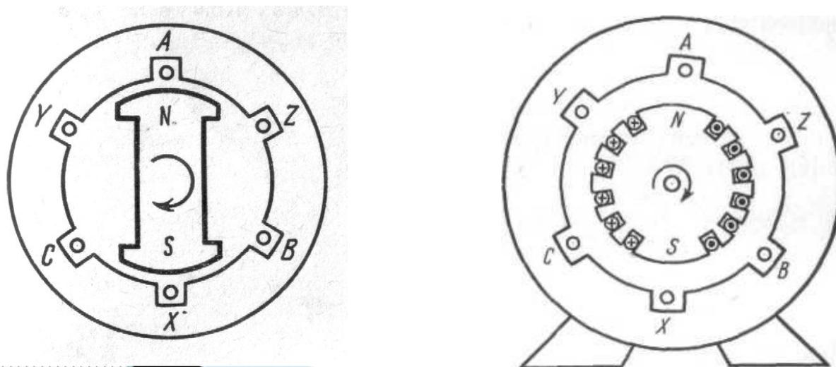
При вращении ротора, представляющего собой электромагнит (многовитковый проволочный), возбуждаемый постоянным током, в неподвижных обмотках статора наводятся ЭДС, имеющие одинаковые амплитуды и сдвинутые по фазе относительно друг друга на угол  $120^\circ$ .
