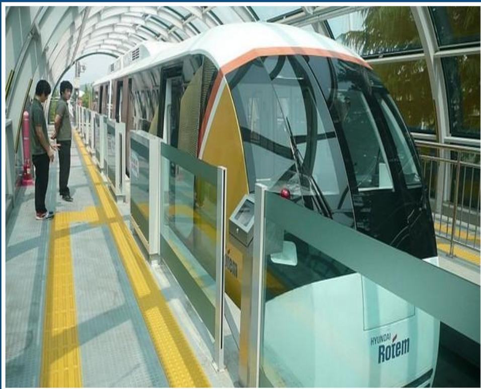
Поезд на магнитной подушке Linimo, эксплуатация которого началась в марте 2005 года, был разработан компанией Chubu HSST и до сих пор используется в Японии. Он курсирует между двумя городами префектуры Айти. Протяженность полотна, над которым парит маглев составляет около 9 км (9 станций). При этом максимальная скорость Linimo равна 100 км/ч. Это не помешало ему только в течение первых трех месяцев с момента запуска перевезти более 10 млн пассажиров.
