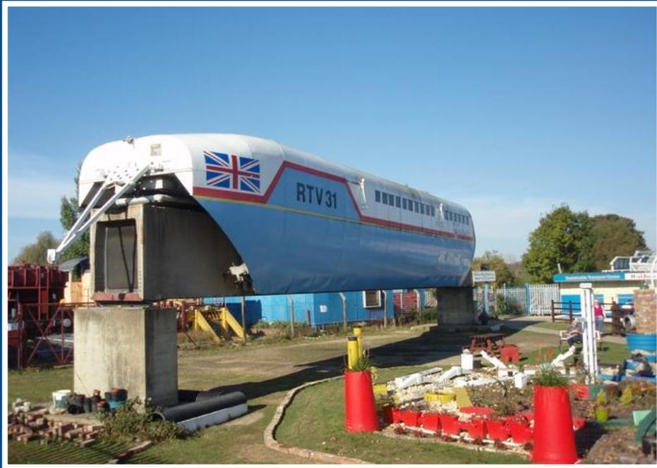
Прототип поезда с линейным двигателем RTV 31
