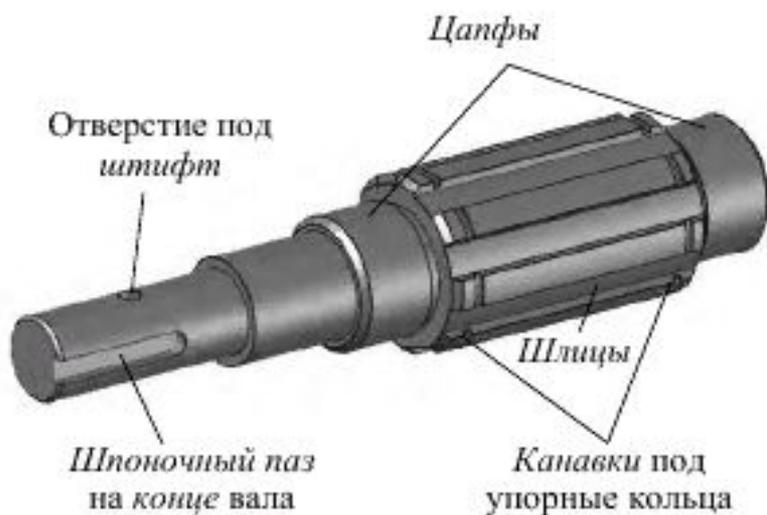
Рис. 1.1. Вал с цилиндрическими ступенями
