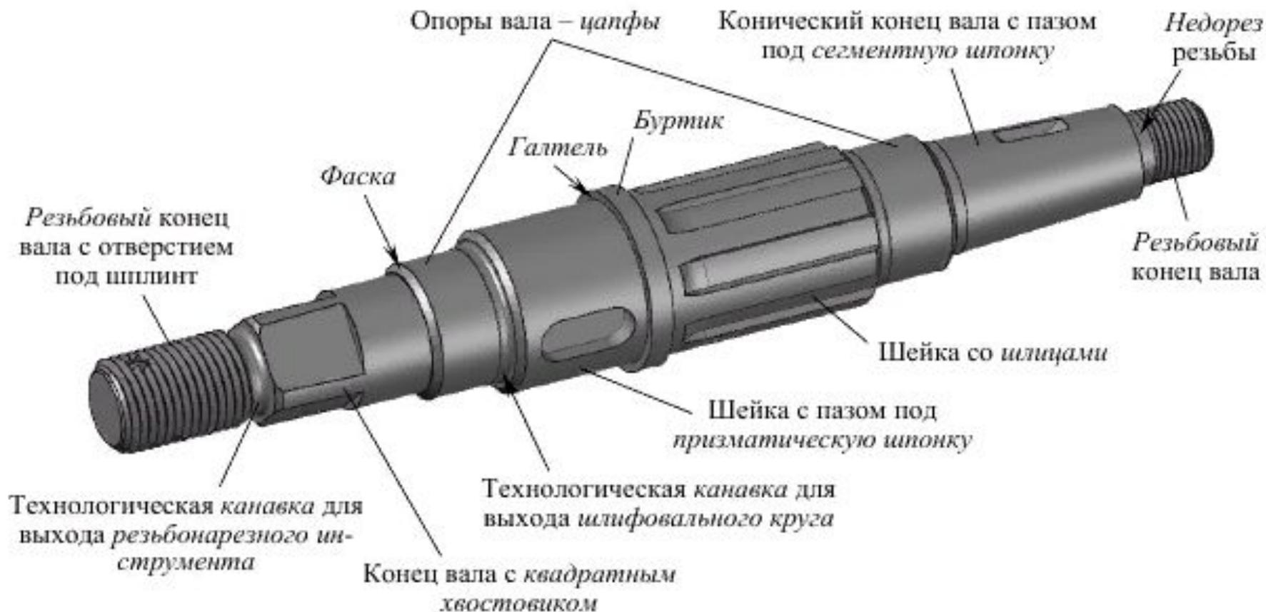
Рис. 1.2. Вал, комбинированный из ступеней разной формы с конструктивными элементами для фиксирования насаживаемых деталей и технологическими канавками
