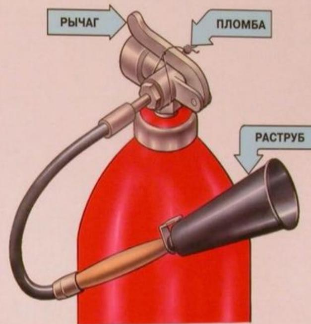
ПРЕДНАЗНАЧЕНЫ для тушения загораний различных веществ и материалов, электроустановок под напряжением до 1000 В, двигателей внутреннего сгорания, горючих жидкостей **ЗАПРЕЩАЕТСЯ** тушить материалы, горение которых происходит без доступа воздуха
