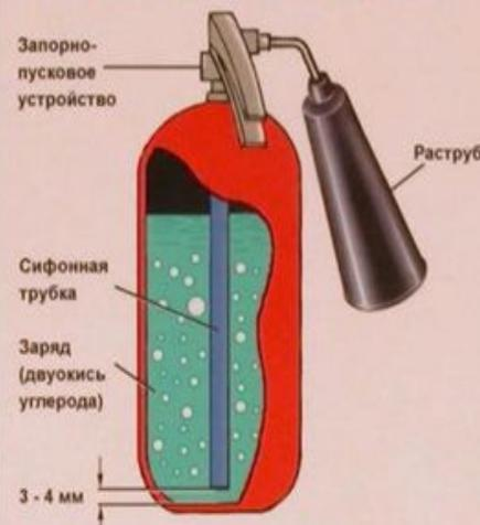
ПРИНЦИП ДЕЙСТВИЯ основан на вытеснении двуокиси углерода избыточным давлением. При открывании запорно-пускового устройства CO<sub>2</sub> по сифонной трубке поступает к раструбу. CO<sub>2</sub> из сжиженного состояния переходит в твердое (снегообразное). Температура резко (до -70° С) понижается. Углекислота, попадая на горящее вещество, изолирует его от кислорода
