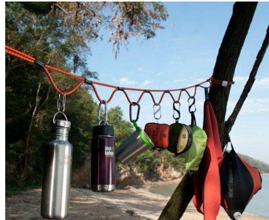
**Карабин** — это разъемное соединительное звено овальной, треугольной, трапецеидальной и другой формы.
