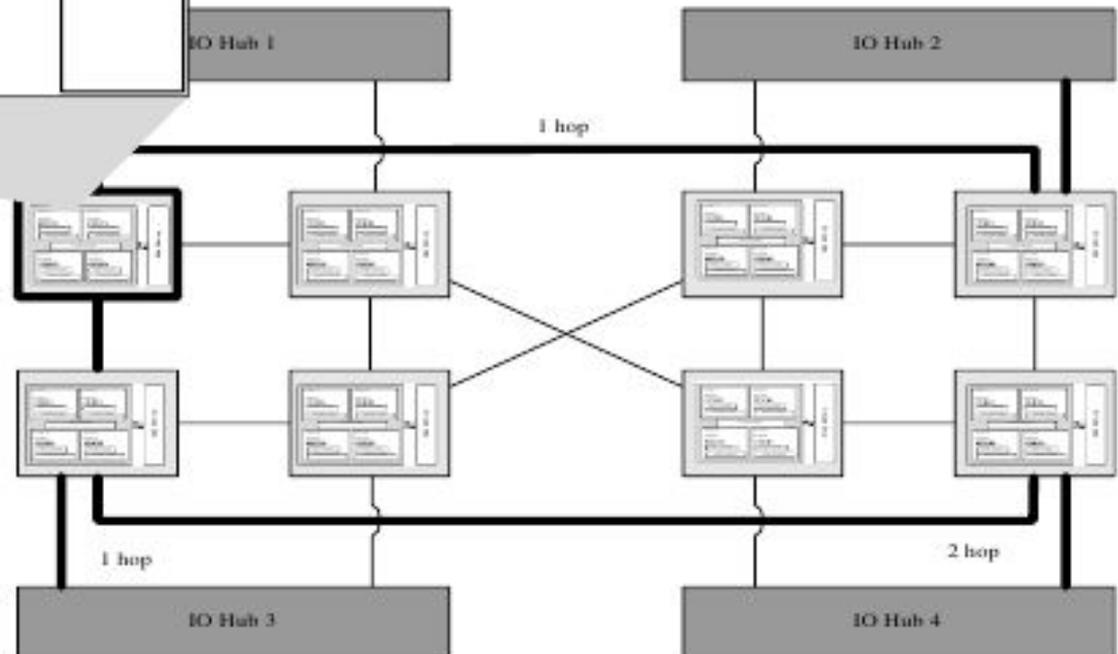
В связи с тенденцией перехода в современных компьютерных системах от многоядерности к многоядерным системам и продолжением роста размера основной памяти, использование Front Side Bus (FSB) архитектуры с Единым доступом к памяти (Uniform Memory Access - UMA) стало узким местом в производительности и привело к тяжелым проблемам в проектировании аппаратных средств для подключения всех ядер и памяти.
