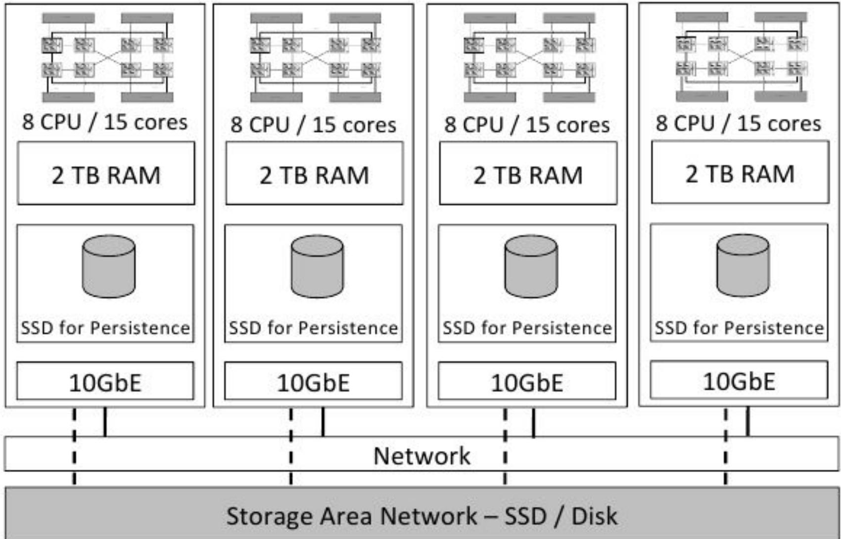
Следующий рисунок показывает пример установки для масштабирования системы управления базами данных на основе основной памяти с использованием нескольких узлов (горизонтально масштабируемое устройство).
