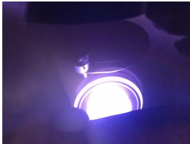
Рисунок 4 - Процесс напыления на установке ЭТНА-100-МТ
