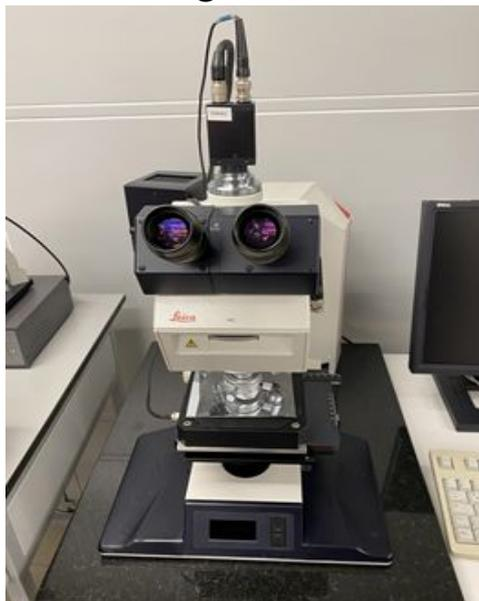
Рисунок 8 - Оптический микроскоп с установкой WLI
