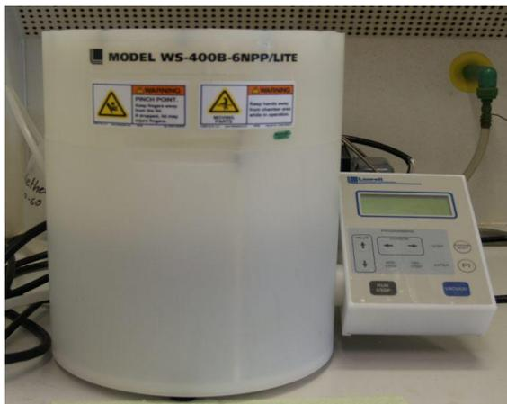
Рисунок 5 - Установка центрифугирования
