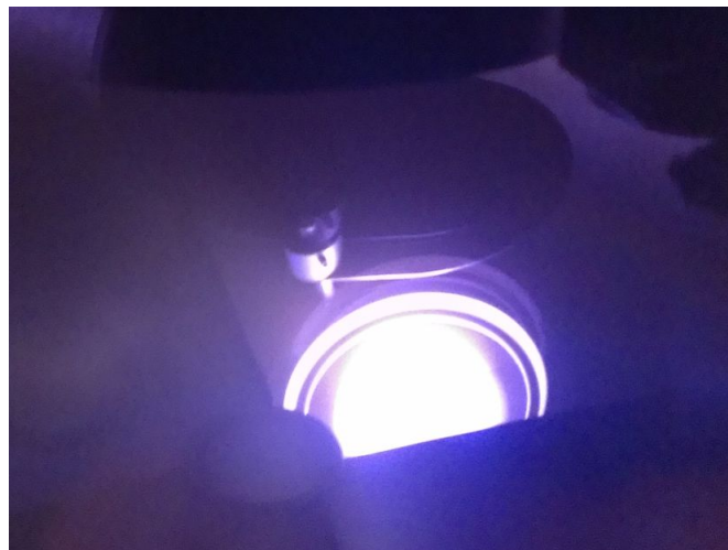
Рисунок 4 - Процесс напыления на установке ЭТНА-100-МТ
