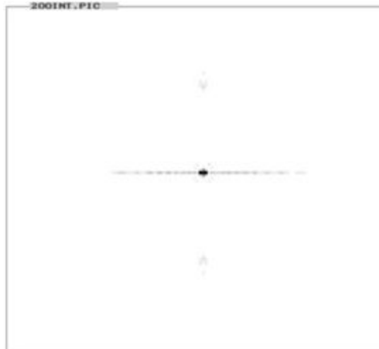
Распределение интенсивности линзы с фокусным расстоянием 200мм
