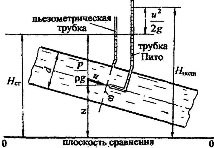
Для определения полного напора по оси потока пользуются трубкой Пито. Это трубка очень малого диаметра с загнутым под углом  $90^\circ$  и гладко обработанным концом. Трубка Пито устанавливается по оси трубы или в любой другой точке потока так, чтобы скорость  $u$  была направлена на входное отверстие трубки.
