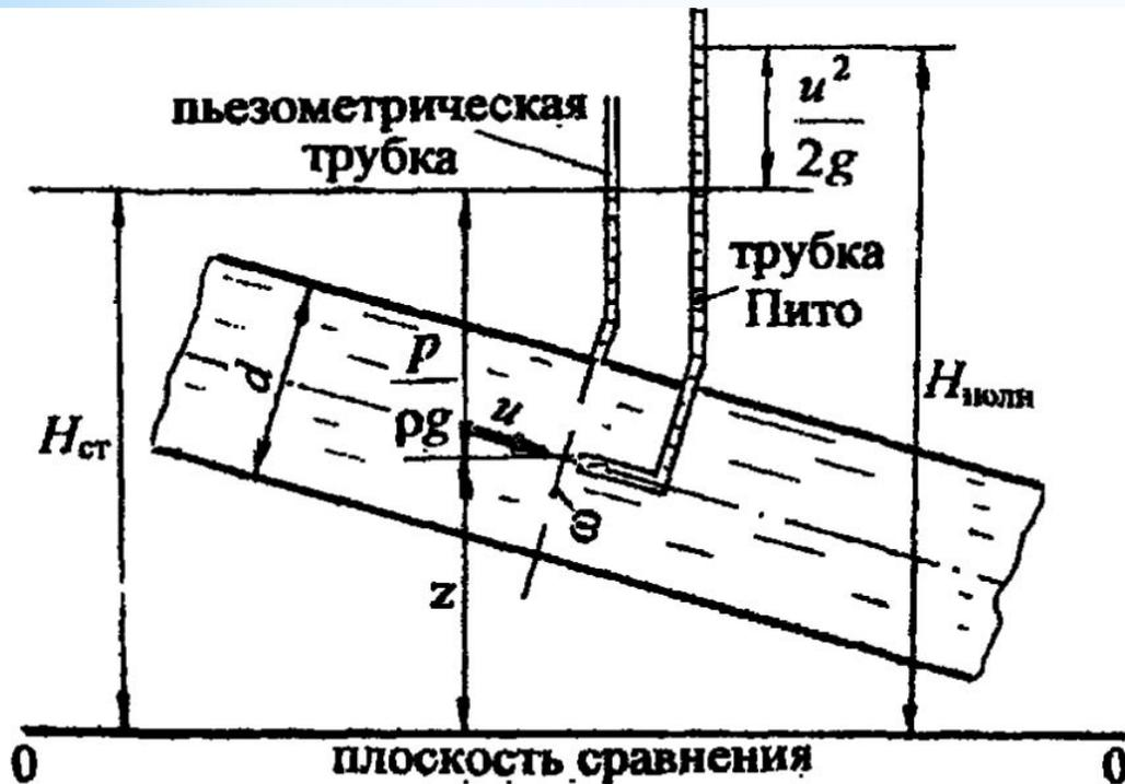
Таким образом, *по показанию пьезометра определяем статический напор:*
