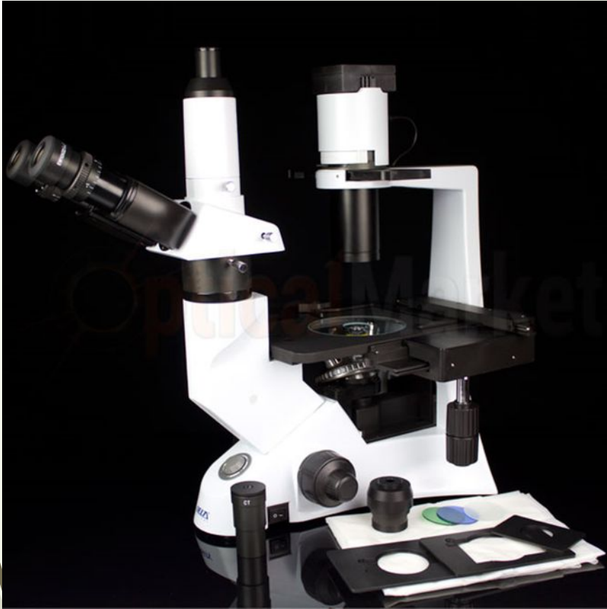
фазовоконтрастный микроскоп - для изуч. живых неокраш-х объектов
