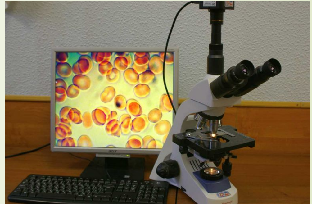
темнопольный микроскоп (для изуч. живых неокраш-х объектов). Темнопольная микроскопия позволяет наблюдать живые объекты.
