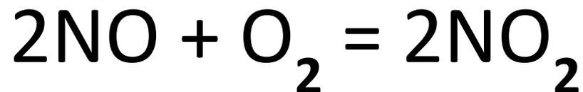
КИНЕТИЧЕСКОЕ УРАВНЕНИЕ:  $V_{\text{х.р.}} = k \cdot (C_{\text{NO}})^2 \cdot (C_{\text{O}_2})^1$
