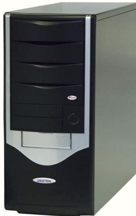
Корпуса, имеющие **вертикальное** исполнение, различают по габаритам: *полноразмерный* (big tower), *среднеразмерный* (midi tower) и *малоразмерный* (mini tower).
