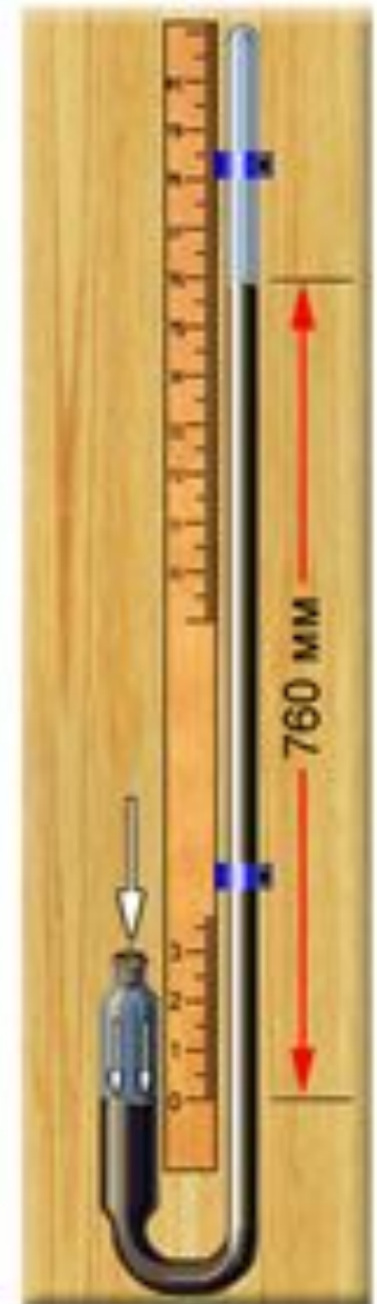
СХЕМАТИЧЕСКОЕ УСТРОЙСТВО РТУТНОГО БАРОМЕТРА
