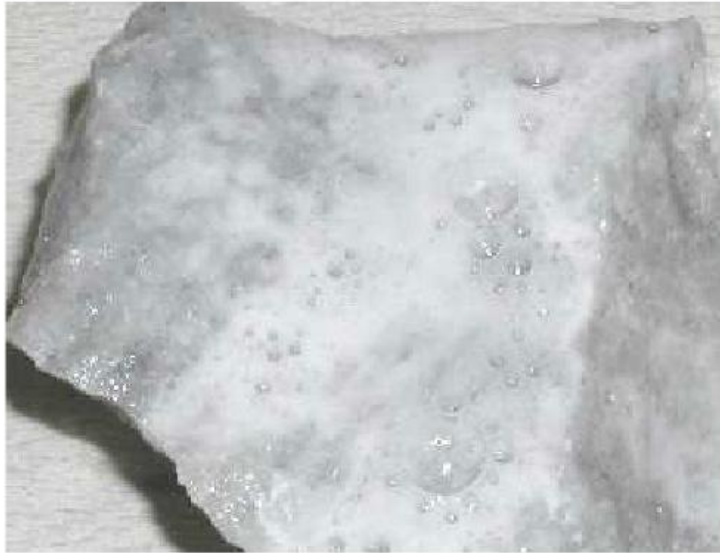
Реакция кальцита с разбавленной соляной кислотой
