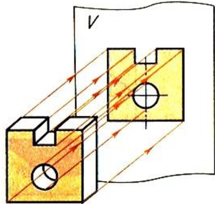
Заметьте, что предмет был расположен перед плоскостью проекций так, что две его поверхности оказались параллельными этой плоскости и спроецировались без искажения. По полученной проекции мы сможем судить лишь о двух измерениях предмета в данном случае — **высоте и ширине** и с
