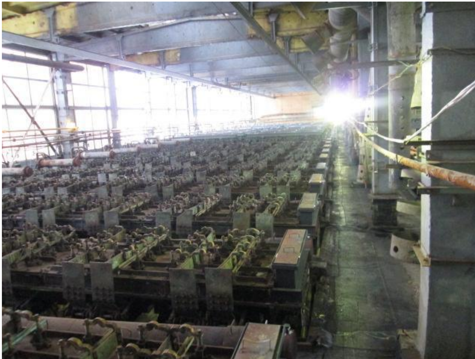
Зал ртутного электролиза до модификации, осуществленной компанией DeNora, начиная с 2010 г. и законченной в 2014 г.
