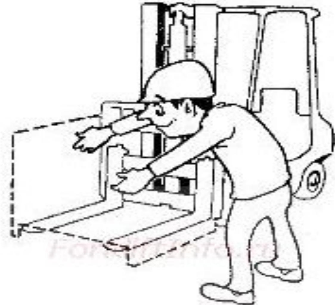
При перевозке длинных грузов и отсутствии центровки, может произойти опрокидывание погрузчика.
