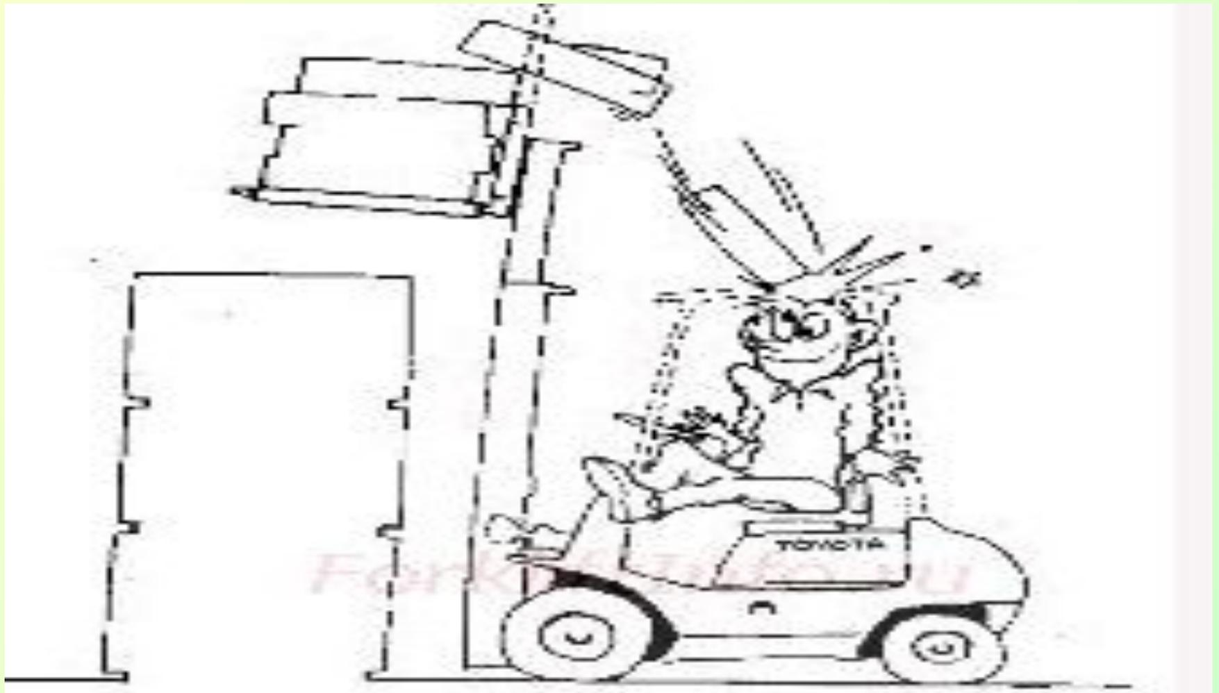
При подъеме груза рама погрузчика должна быть вертикальной или наклоненной назад. **Нельзя** поднимать груз с наклоненной вперед рамой погрузчика.
