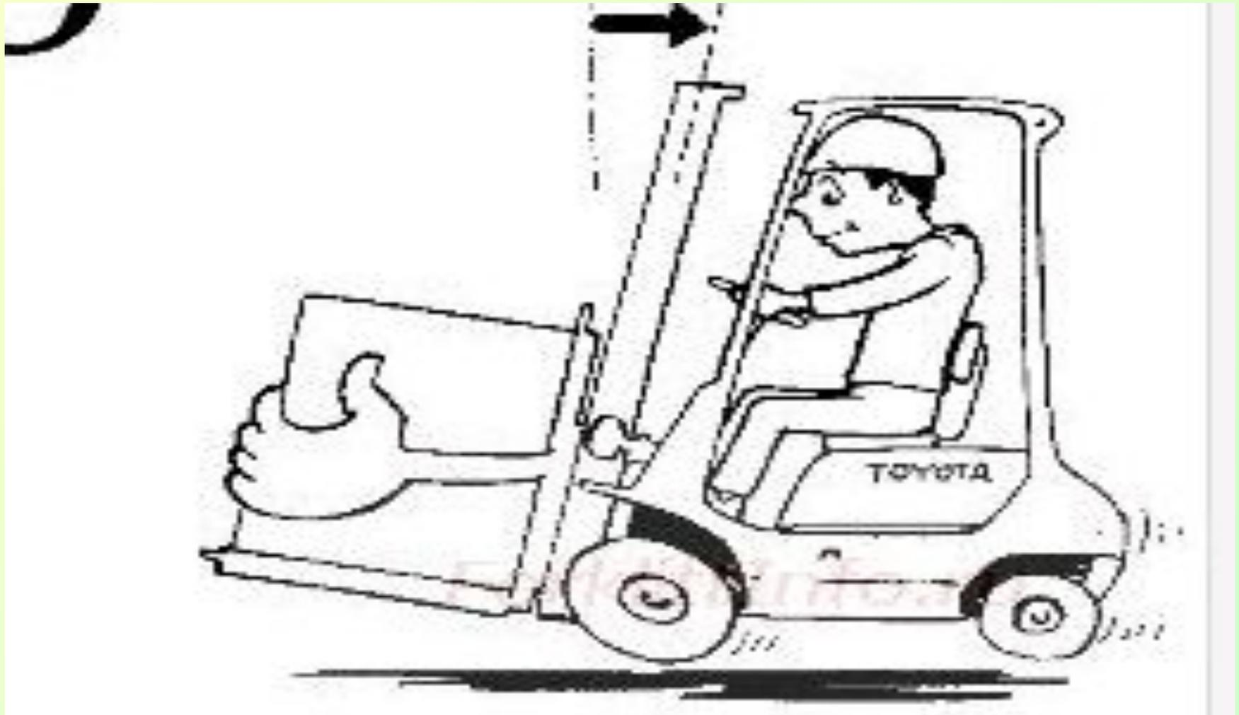
**Перед началом движения электропогрузчика убедиться, что рычаг направления находится в требуемом направлении передвижения, и отсутствуют любые препятствия для движения.**
