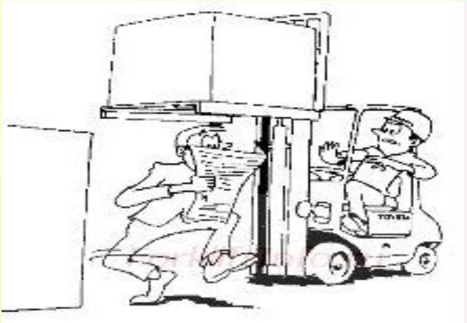
Не допускается протягивание рук через рамы погрузчика.
