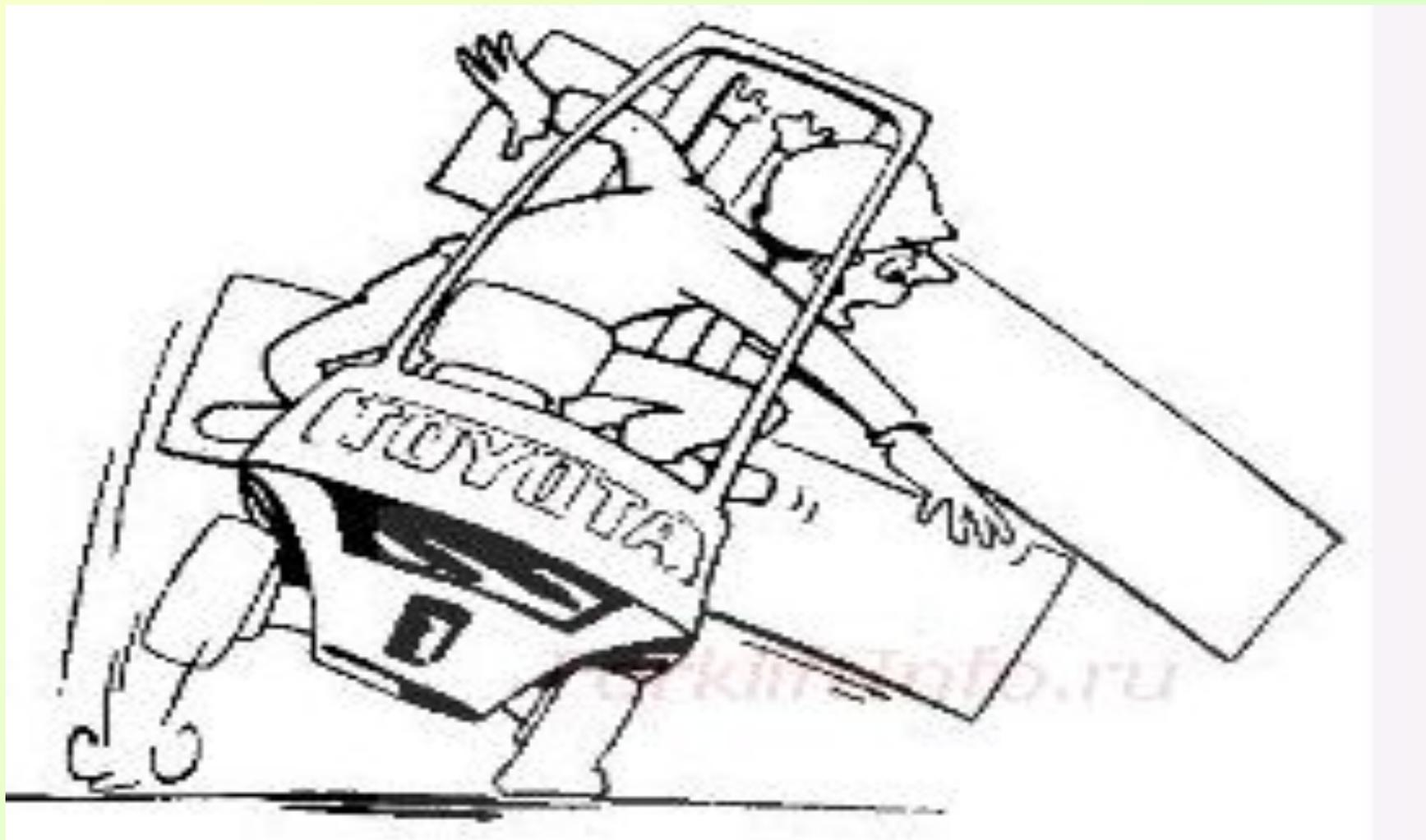
**Наклон и высоко поднятый груз может вызвать опрокидывание погрузчика.**
