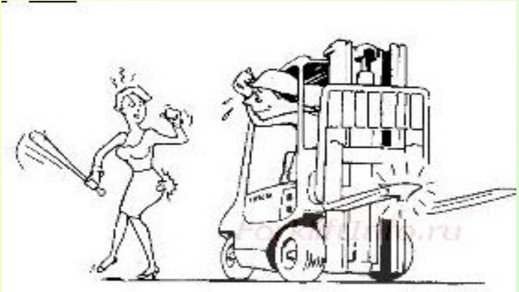
Для обеспечения лучшей видимости при работе с **объемными** грузами допускается двигаться задним ходом, при возможности иметь помощника – проводника.
