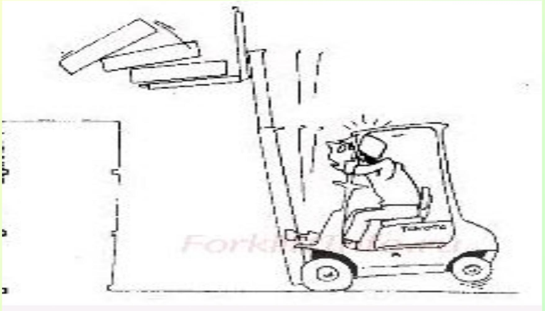
При транспортировании груза поднимать его на высоту не более 200-300 мм от поверхности пути.
