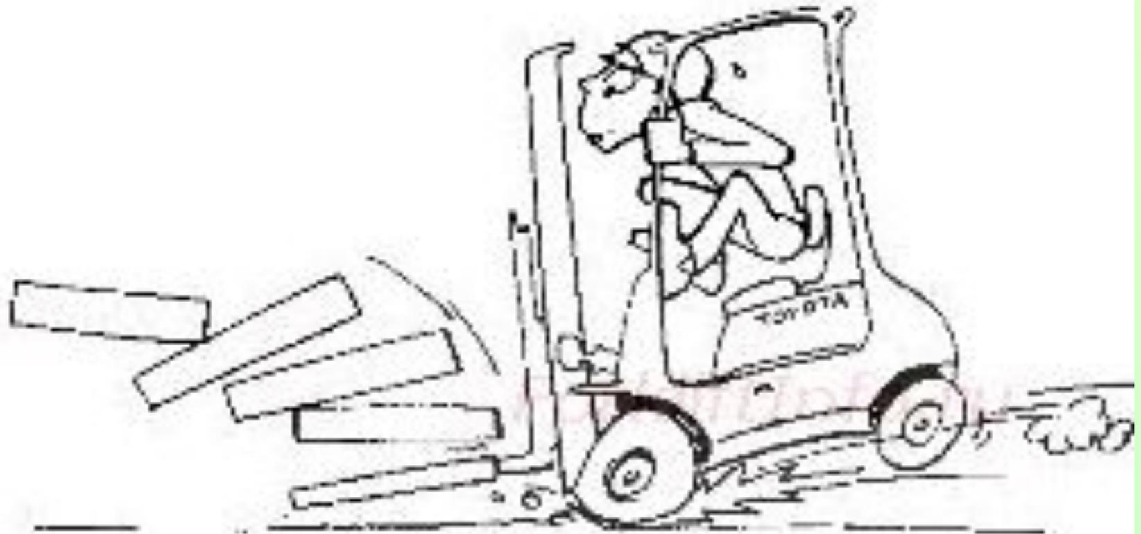
При движении ЭП выполнять все требования безопасности и знать все предельные значения, в т.ч. скорость и т.д..(не превышать на территории скорость **5 км/час**, в узких местах, в помещениях и на поворотах, при движении мимо ворот, дверей, штабелей **3 км/час**).
