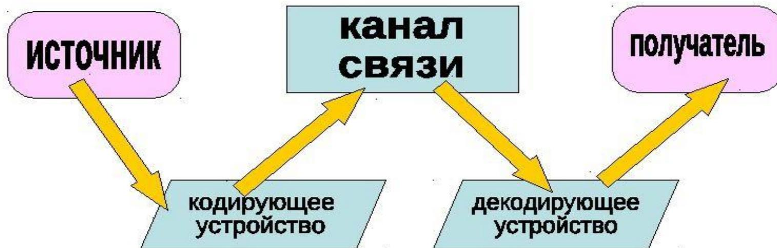
устройство, предназначенное для преобразования исходного сообщения источника информации к виду, удобному для передачи
