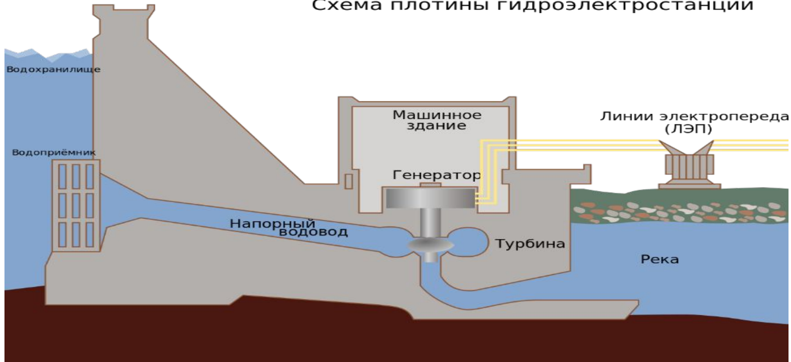
Схема плотины гидроэлектростанции
