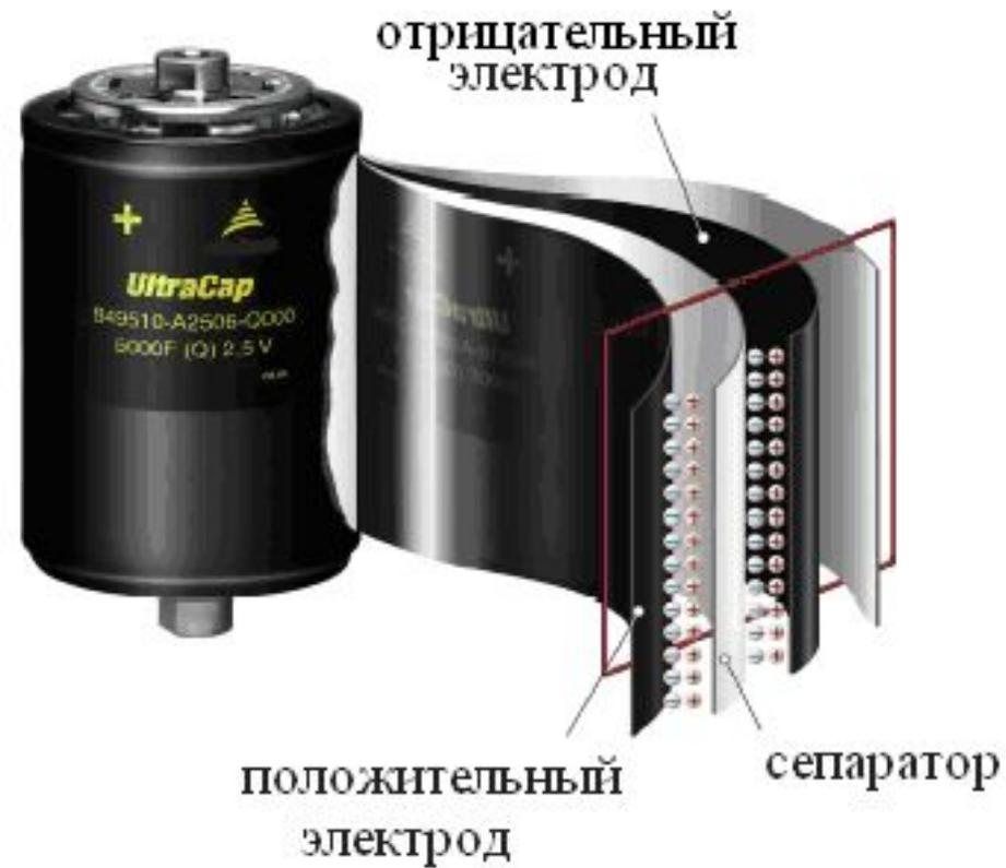
Рис. 34. Конструктивное исполнение КДЭС
