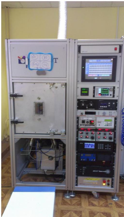
Установка магнетронного распыления ЭТНА100-МТ В
