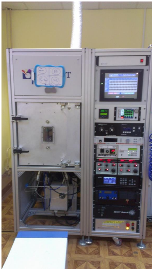
Установка магнетронного распыления ЭТНА100-МТ В НОЦ НТ СГАУ( НТ-МДТ, г. Зеленоград)
