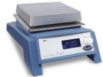
Сушка фоторезиста на плитке SD160 Stuart
