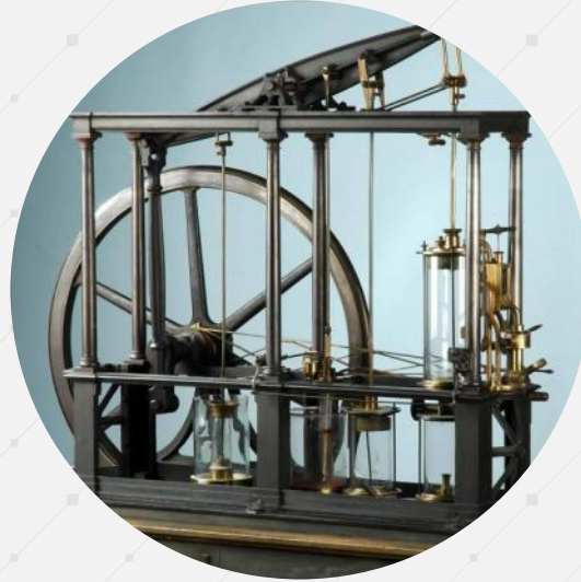
Регулятор скорости паровой машины Д. Уатта. 1784 год
