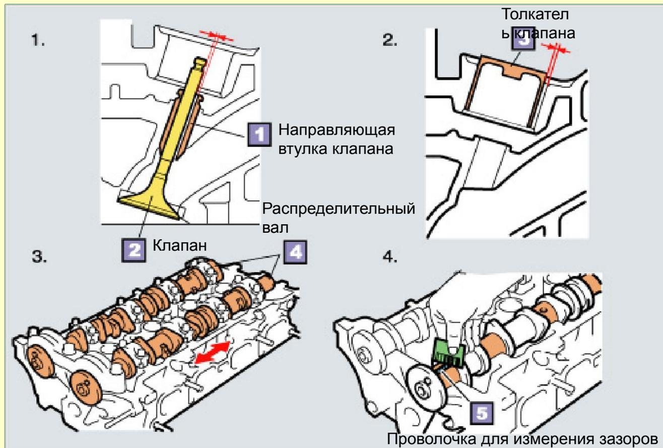
1. Масляный зазор направляющей втулки клапана
