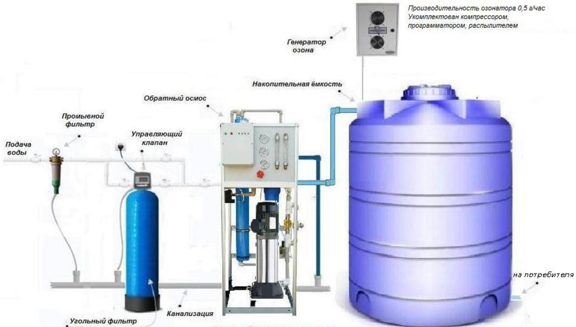
*Обратный осмос укомплектован автоматикой уровня, автоматикой промывки, системой впрыска антискаланта, линией рециркуляции.*
