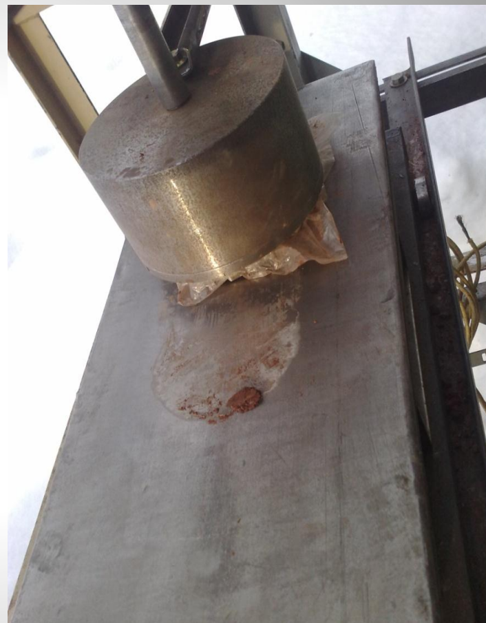
Поверхность имитатора после сдвига
