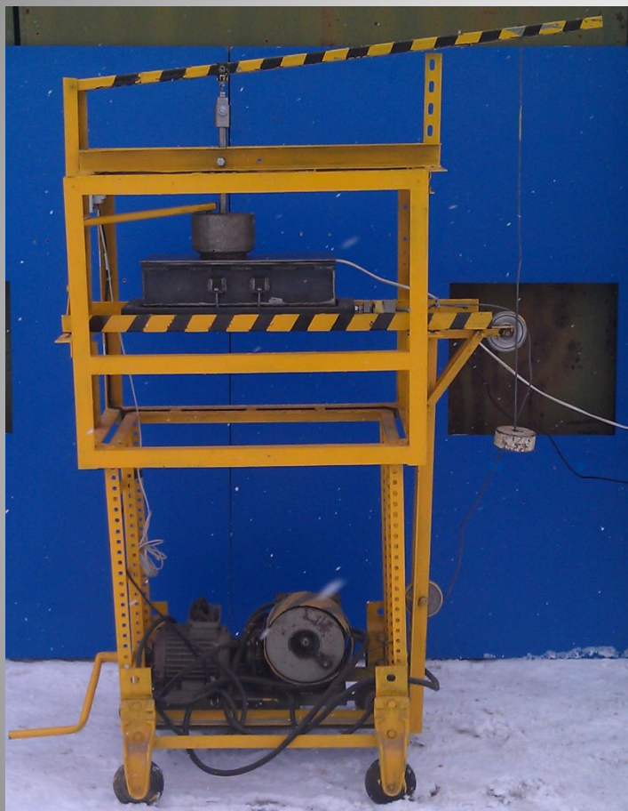
Экспериментальный сдвиговой стенд
