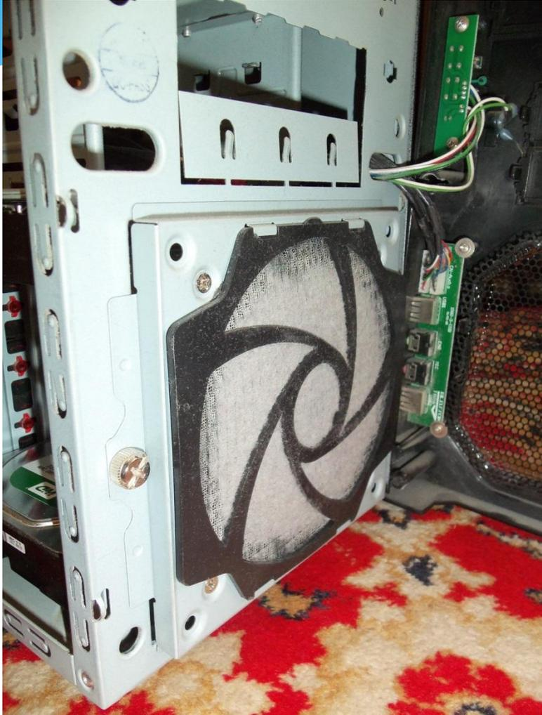
Фильтрующая решетка вся в пыли, её также промываем под проточной водой и кладем сохнуть на батарею отопления.
