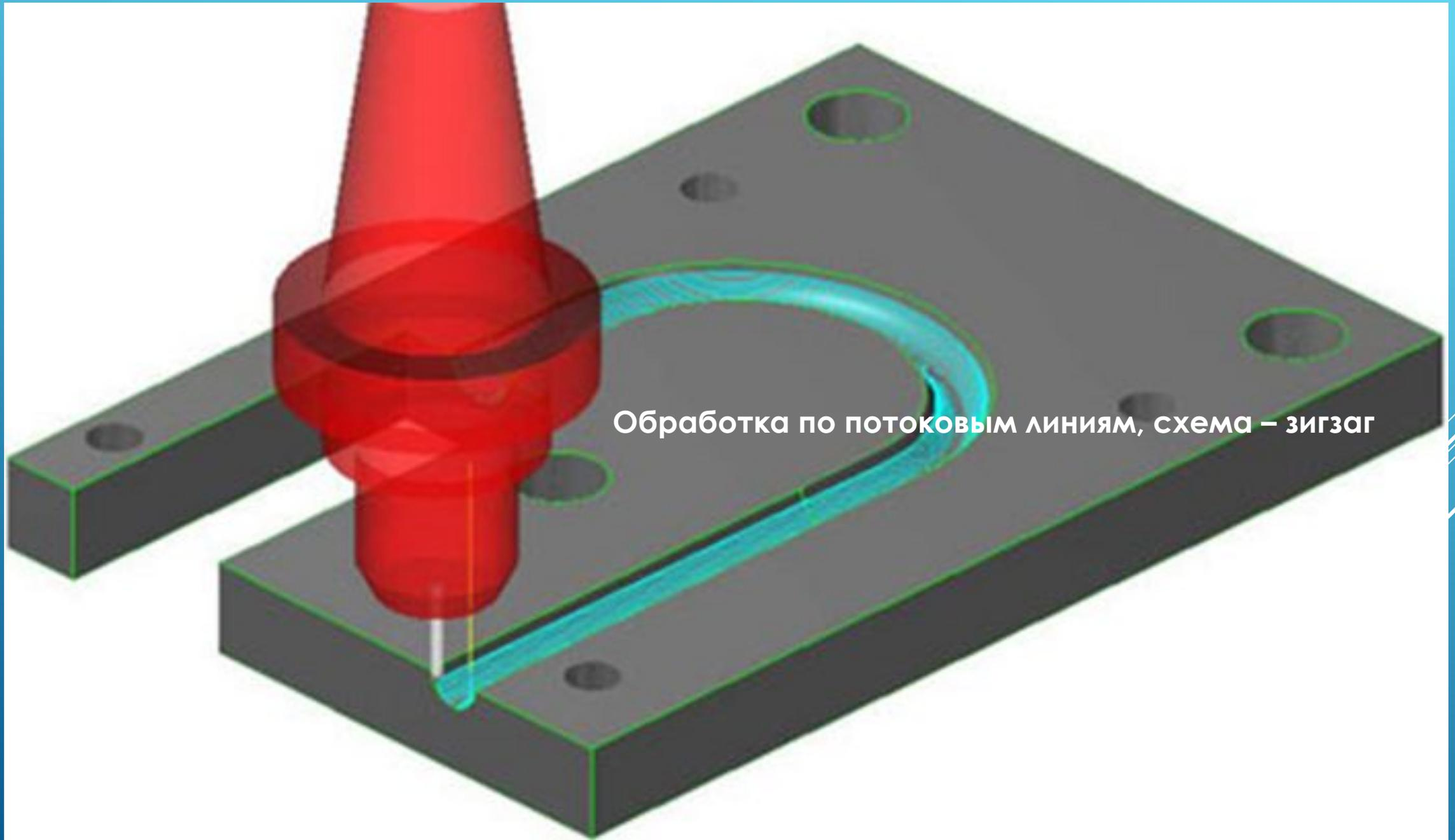
Обработка по потоковым линиям, схема – зигзаг
