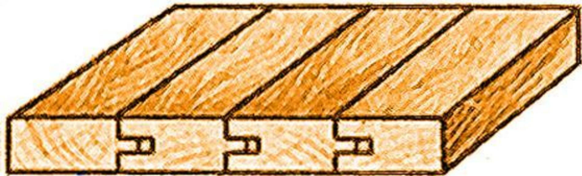
**Сплачивание в паз и гребень**
