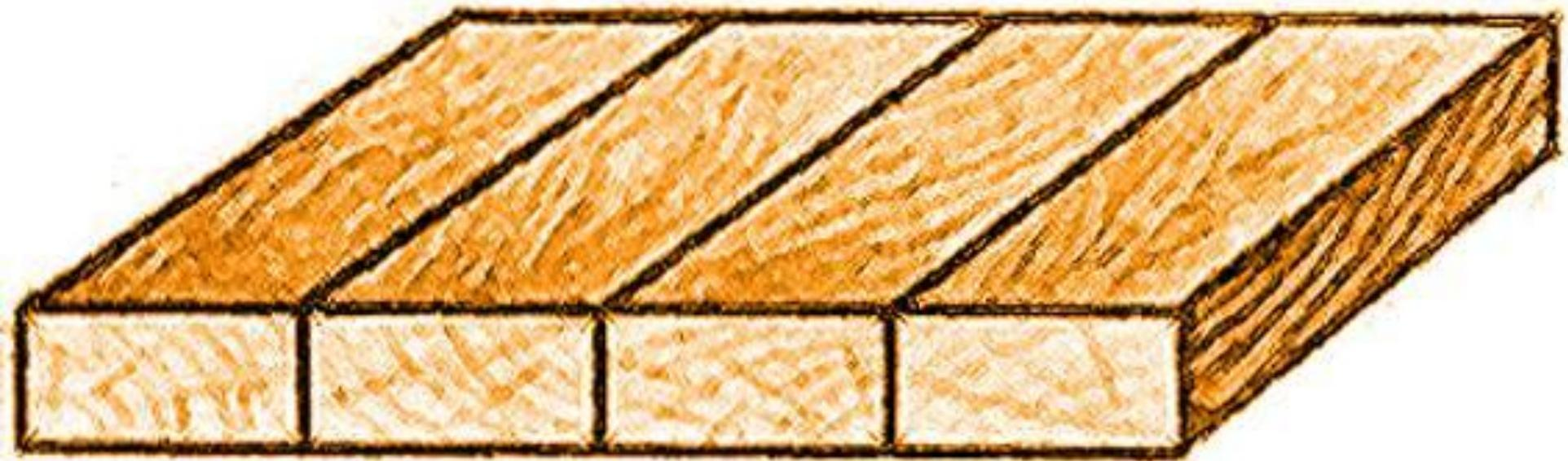
**Сплачивание на гладкую фугу**
