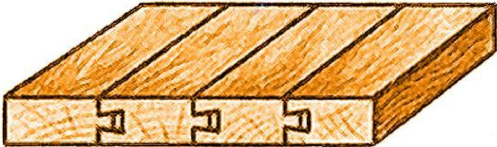
**Сплачивание в «ласточкин хвост»**
