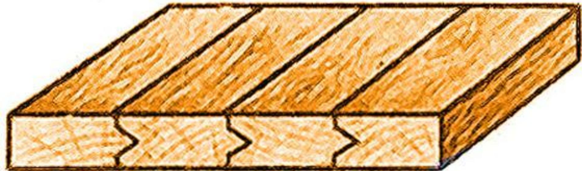
**Сплачивание в паз и треугольный гребень**
