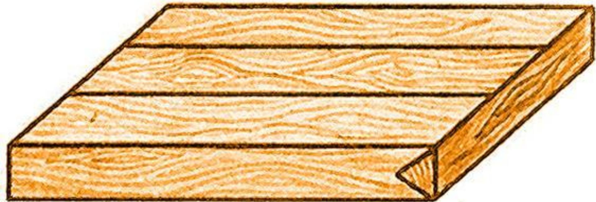
**Щит со вклеенной треугольной рейкой**
