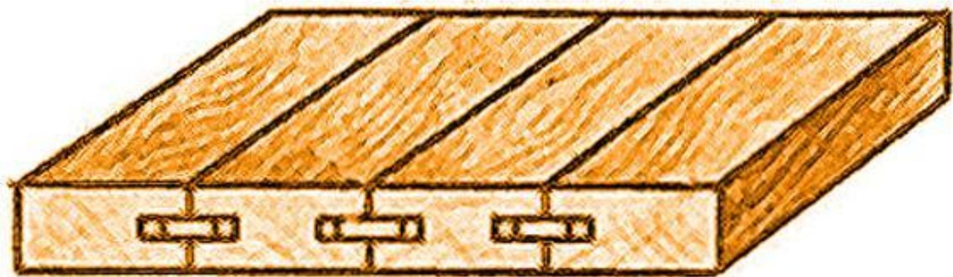
**Сплачивание на рейку**
