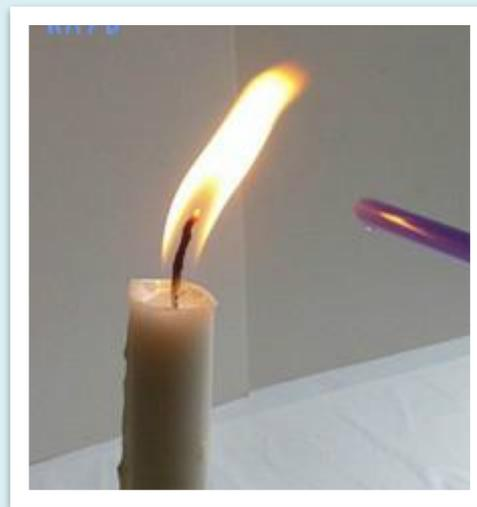
*Напротив трубки зажигаем свечу. Через трубку продуваем воздух, пламя свечи отклоняется в сторону трубки.*
