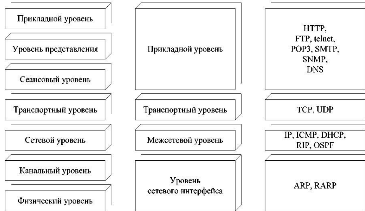
Рис. 2.2. Соответствие протоколов TCP/IP моделям OSI и DARPA
