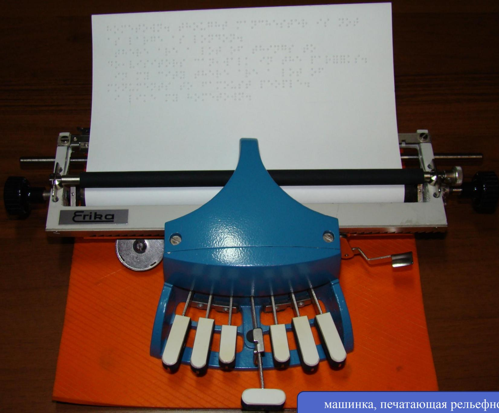
машинка, печатающая рельефно-точечным шрифтом по системе Брайля
