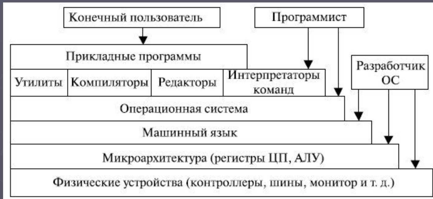
Иерархическая структура программно-аппаратных средств компьютера
