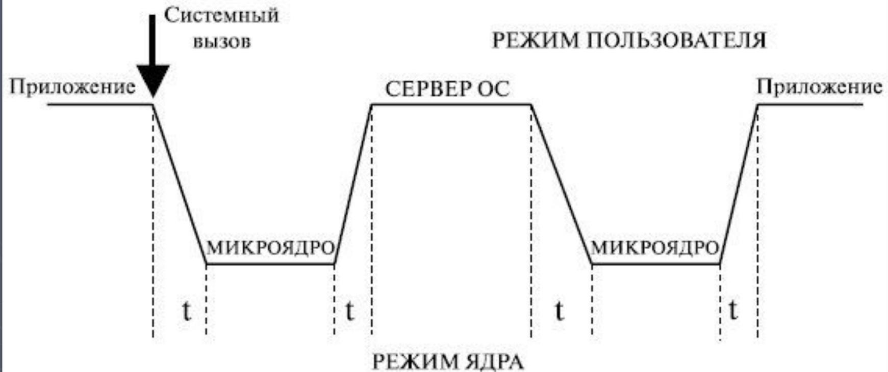
Обработка системного вызова в микроядерной архитектуре
