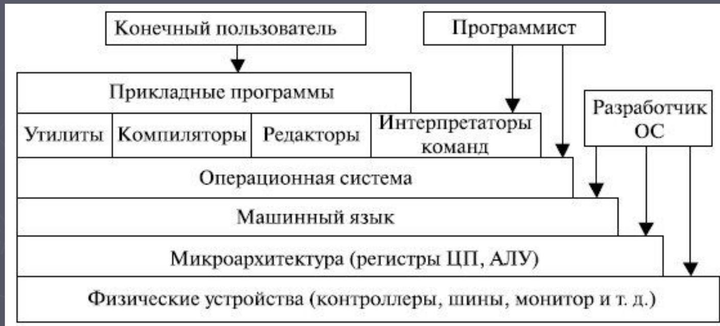
Иерархическая структура программно-аппаратных средств компьютера
