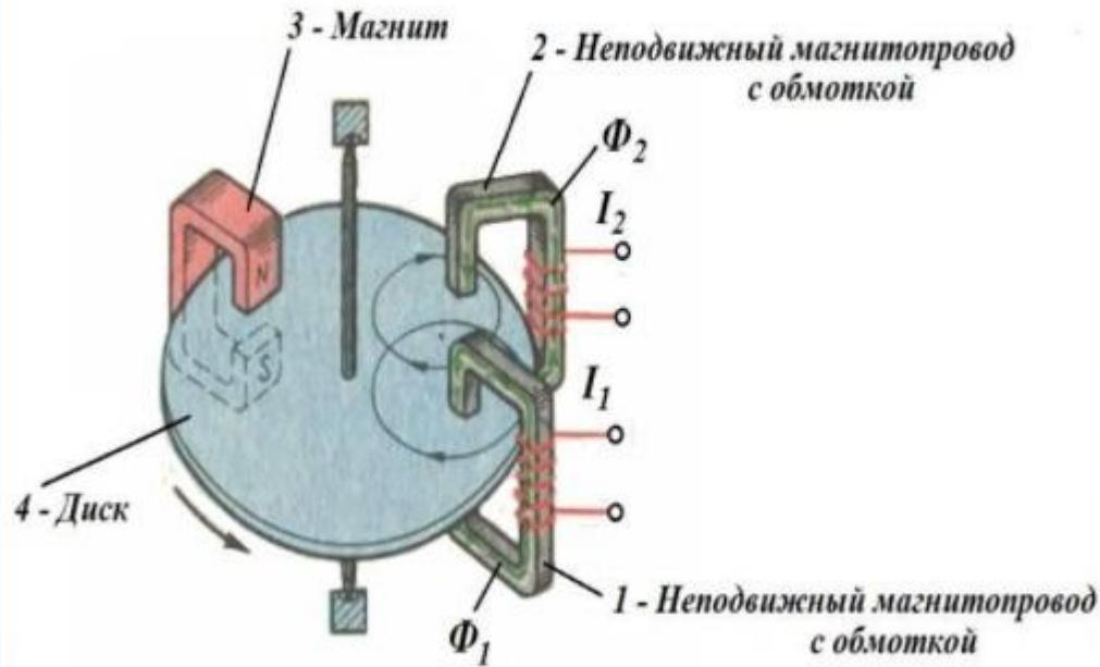
К достоинствам индукционных приборов следует отнести их большую надежность в работе, значительную перегрузочную способность по току (~300%), незначительную чувствительность к внешним магнитным полям и большое значение врачающего момента.
