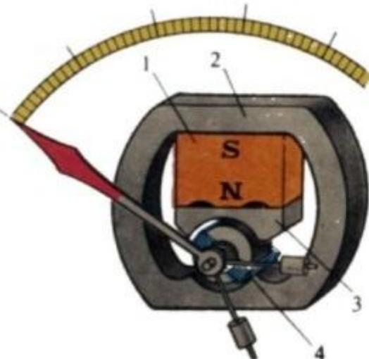
Магнитоэлектрический механизм с внешним магнитом:
