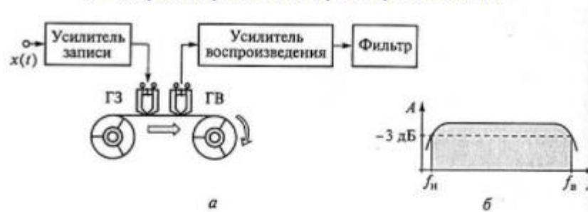
Магнитограф с частотно-модулированной записью:
