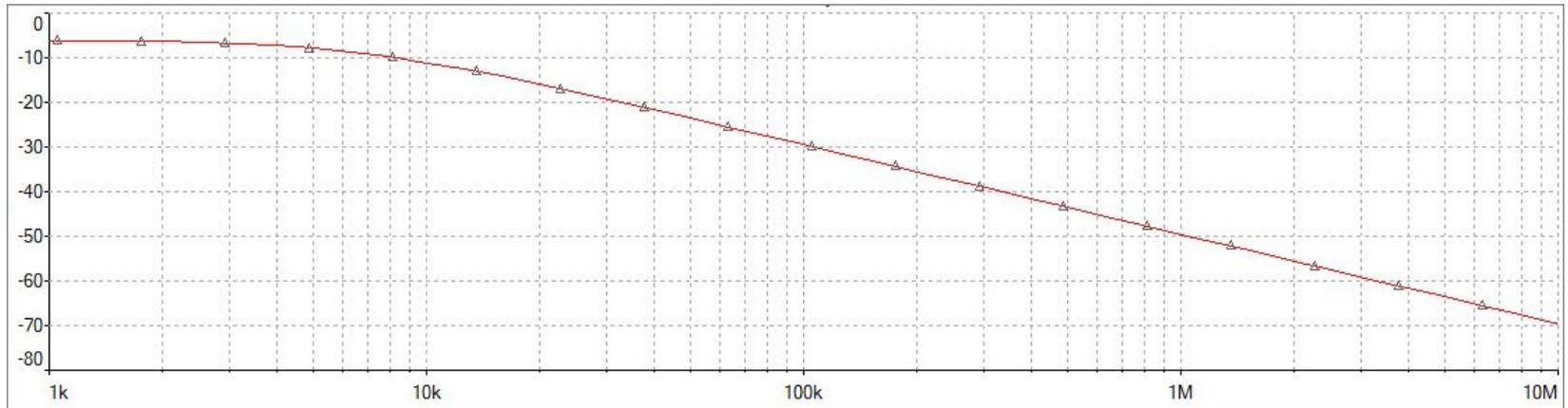
АЧХ фильтра В84112G при схеме подключения для исследования подавления поперечных помех
