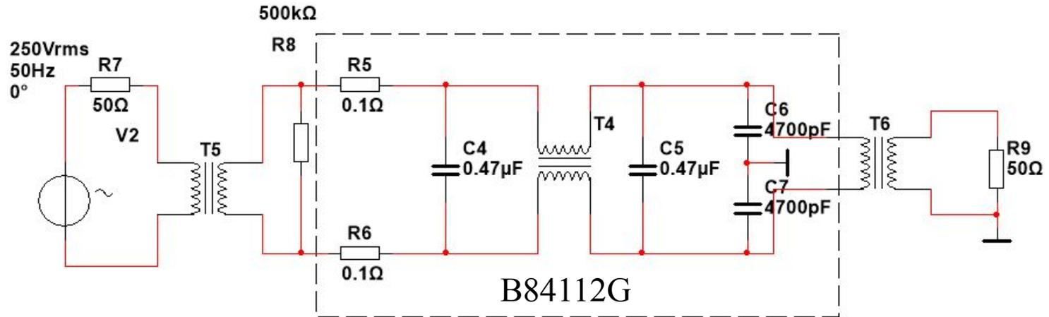
Схема подключения фильтра В84112G для исследования подавления поперечных помех.
