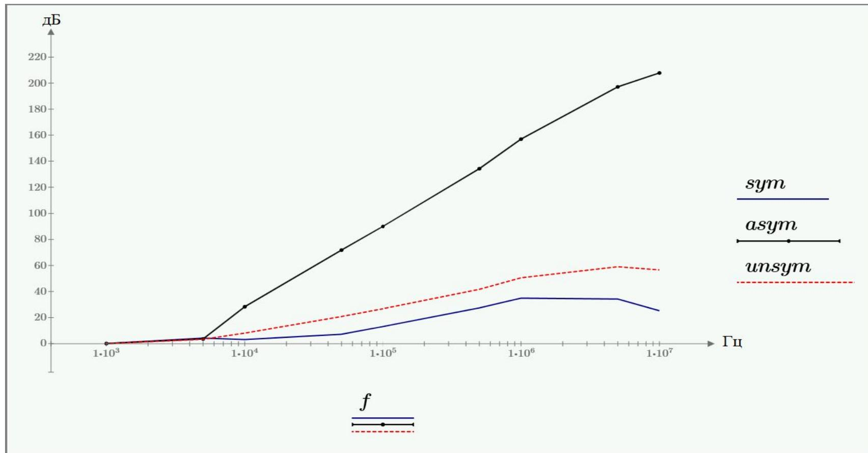
Зависимость коэффициента затухания от частоты помехи для фильтра В84113С с реальными компонентами в режимах подавления поперечных (*sym*), продольных (*asym*) и комбинации помех (*unsym*).
