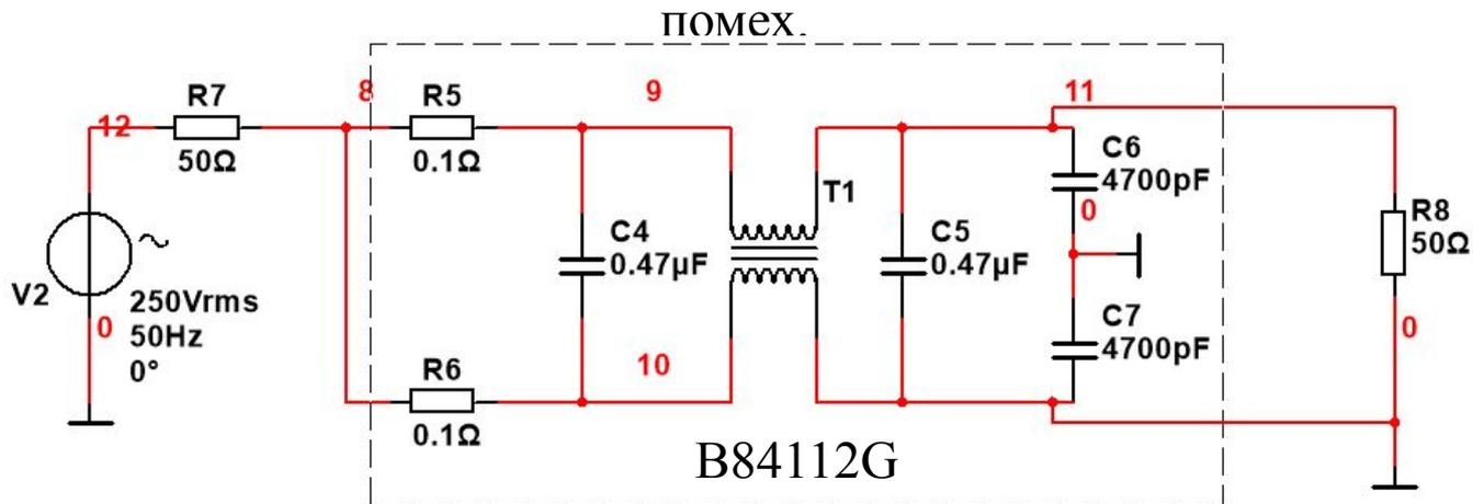
Схема подключения фильтра В84112G для исследования подавления продольных помех.
