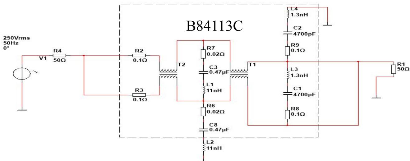
Схема подключения фильтра В84113С для исследования подавления продольных помех с реальными компонентами.
