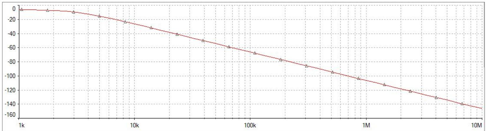
АЧХ фильтра В84112G при схеме подключения для исследования подавления продольных помех
