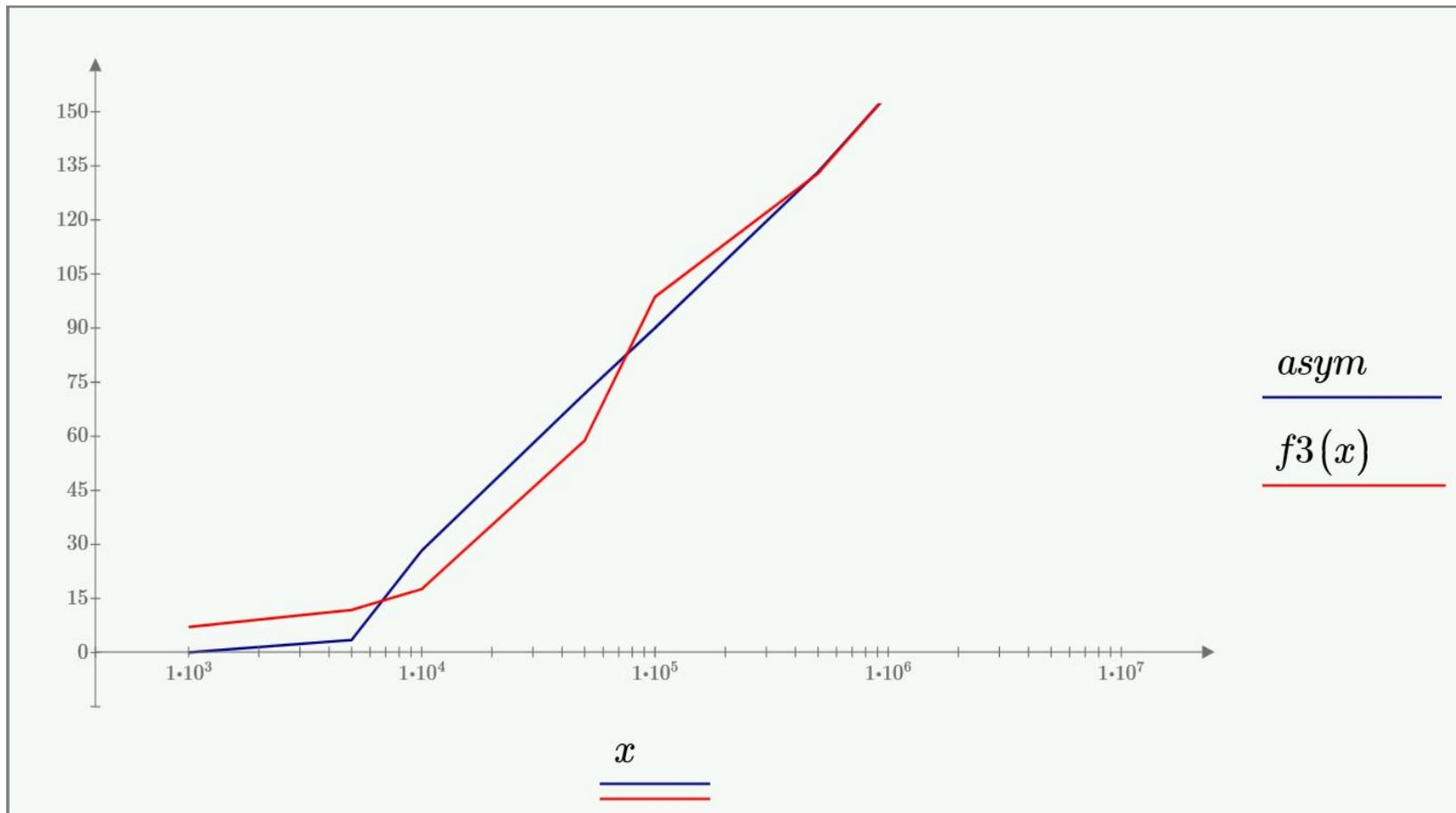
График аппроксимированной кривой зависимости значений коэффициента затухания от частоты при подключении схемы фильтра с реальными компонентами для подавления продольных помех.
