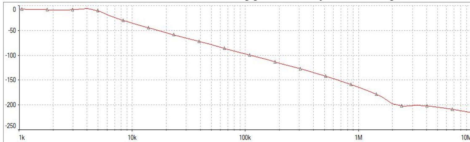
АЧХ при схеме подключения фильтра для исследования подавления продольных помех с реальными элементами.  $A = 62$  дБ/дек - Коэффициент затухания – скорость спада АЧХ.
