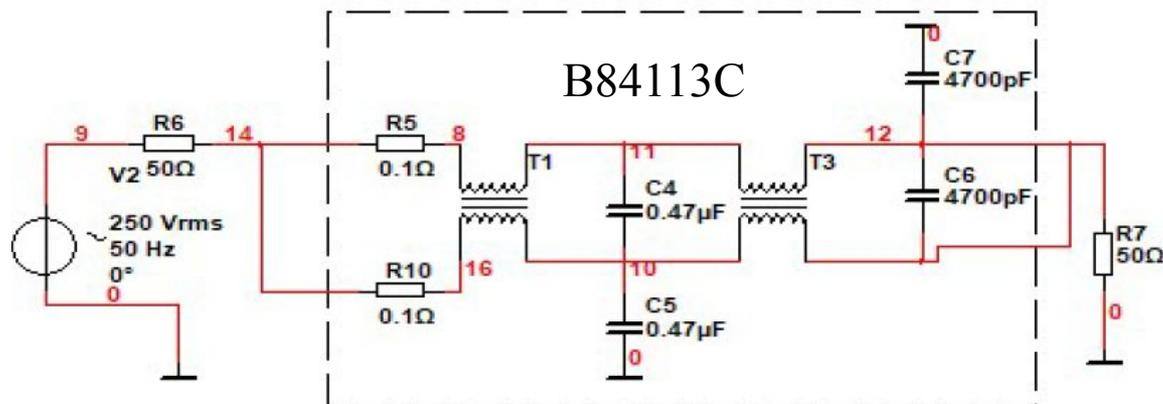
Схема подключения фильтра В84113С для исследования подавления продольных помех с идеальными компонентами.
