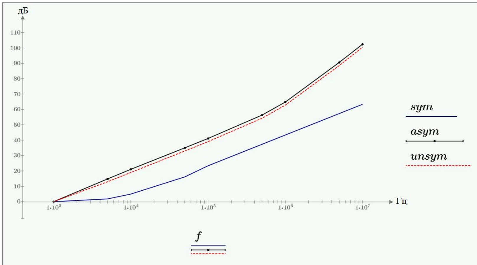
Зависимость коэффициента затухания от частоты помехи для фильтра В84112G в режимах подавления поперечных (*sym*), продольных (*asym*) и комбинации помех (*unsym*).
