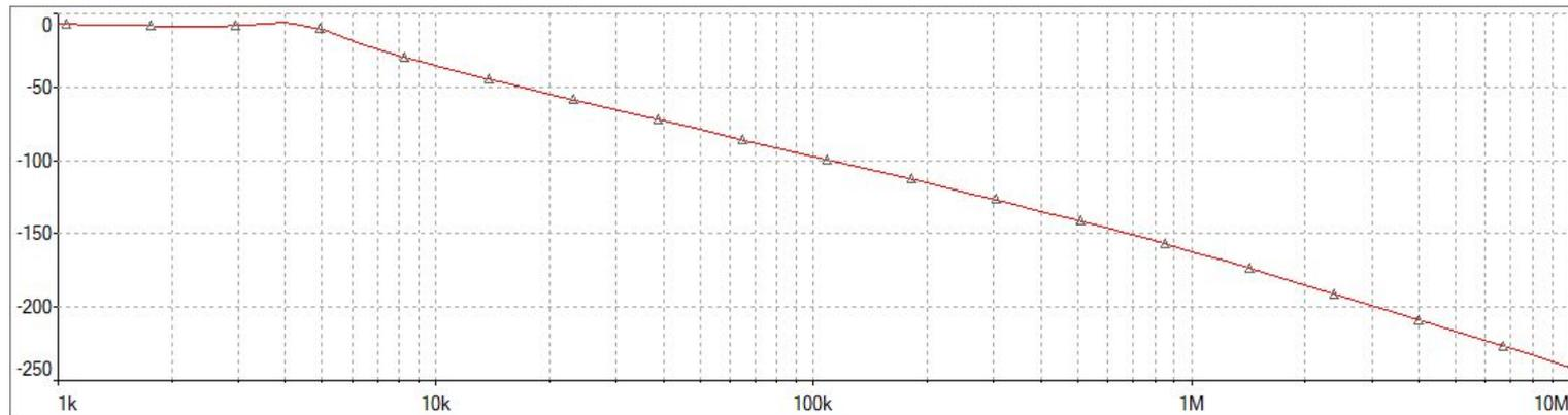
АЧХ при схеме подключения фильтра для исследования подавления продольных помех с идеальными элементами.  $A = 62$  дБ/дек - Коэффициент затухания – скорость спада АЧХ.
