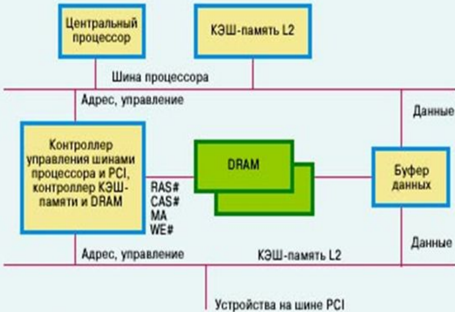
Рис. 3. Один из классических вариантов взаимодействия с подсистемой памяти
