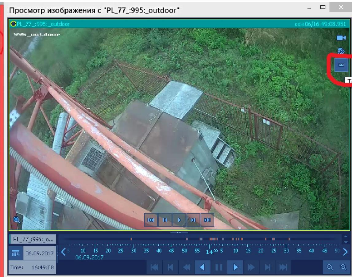
**Внизу отображаются все события от всех базовых станций. Событиям присваиваются дата/время, тип события, имя устройства и т.д.**
