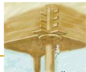
Устройство против мышей на свае амбара
